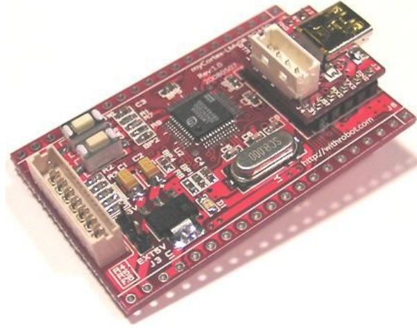
그림 8 myUSB2UART 를 myCortex-LMx08 보드에 바로 연결한 모습 4 핀 커넥터는 제거하고 myUSB2UART 를 연결
